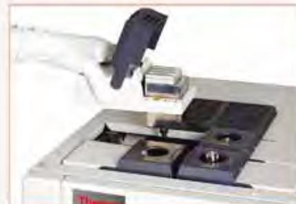
Exemple de remplacement d'un module "Instant Connect" par un utilisateur
